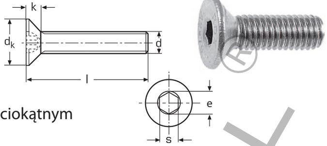
Wkręt do metalu z łbem stożkowym, z gniazdem sześciokątnym
